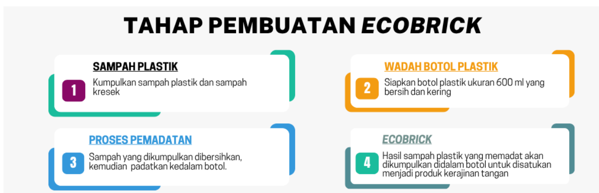
Gambar 2. Tahap pembuatan ecobrick
